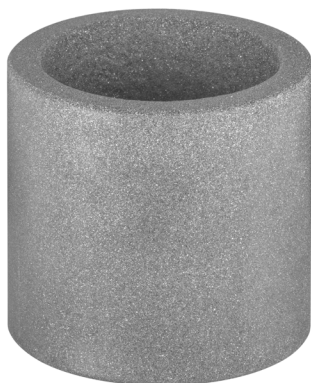
Siliciumcarbid-Prüfkörper mit einer Oberflächenrauheit von 16 Ra
