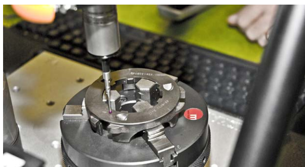
Equator meri deo za ZF Marine.
