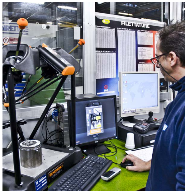
Operater meri deo na Equatoru.
