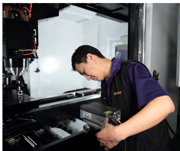
Un dipendente Hartford esegue una calibrazione con l'interferometro laser XL-80
