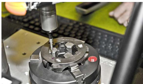
Equator比对仪正在测量ZF Marine的工件
