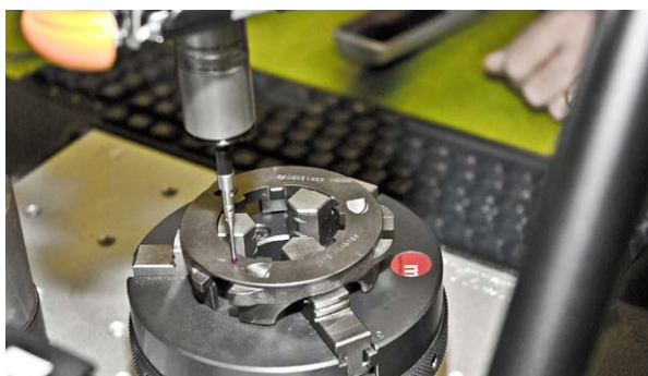
Equator mäter en ZF Marine-detalj
