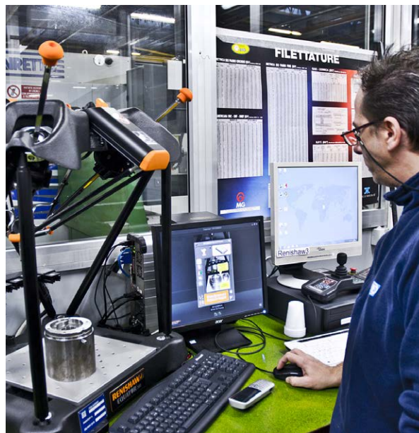
En användare mäter en detalj på Equator.
