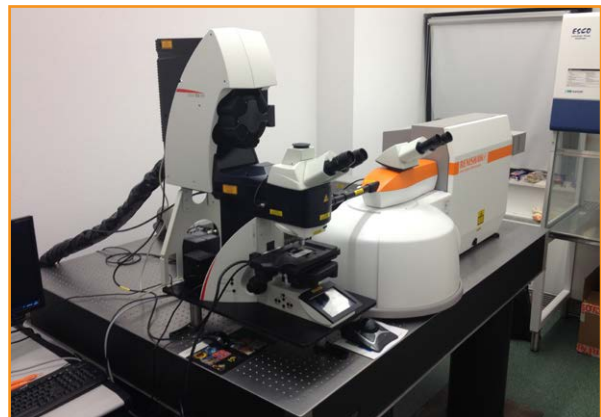
ラマン分光を共焦点レーザー走査型顕微鏡に融合
