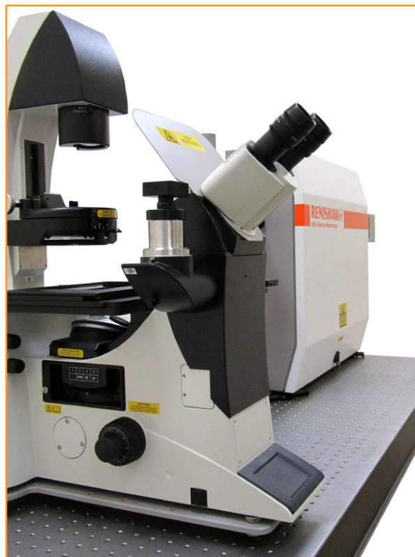
倒立顕微鏡と直立顕微鏡を搭載した inVia
