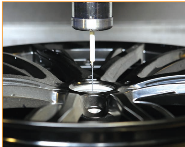
RMP60 正在量測鋁合金輪圈安裝表面
