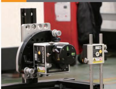
“ 事实证明，雷尼绍XK10激光校准仪已成为我们的制造过程中无可替代的测量和装配工具。XK10紧凑的设计和灵活的夹具组件使其适合应用在全系列Mazak机床上，同时避免了在测量时频繁地拆卸夹具。
