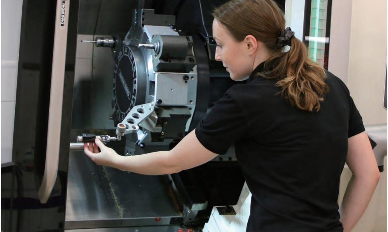
QC20 包括一个精密位移传感器(用于测量球杆仪在绕一个固定点旋转时的半径变化。可根据ISO 230-4、ASME B5.54/57和GB17421.4等国际标准,使用该数据计算被测机器的总体精度测量值(圆度、圆度偏差)。在采用雷尼绍独特的诊断软件及报告格式分析该数据时,还可提供单个误差源的详细诊断
