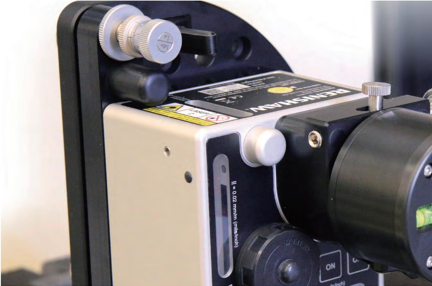
XK10激光校准仪设计用于测量机器的几何量误差与旋转轴心线误差。XK10 配有专用的机床夹具组件，相较于千分表、自准直仪和芯棒等实物标准器，其测量速度更快，操作更简单，功能更强大。
