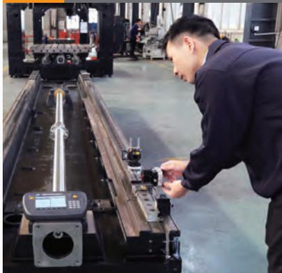
“ 从零部件加工、机床组装到整机测试等多个生产阶段，我们大金集团生产的加工中心均采用了雷尼绍XK10激光校准仪。
