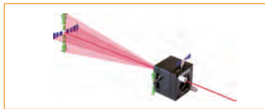
LS350激光准直辅助镜 调整角度范围 \pm 2^\circ 轴向量程 0 – 10m
