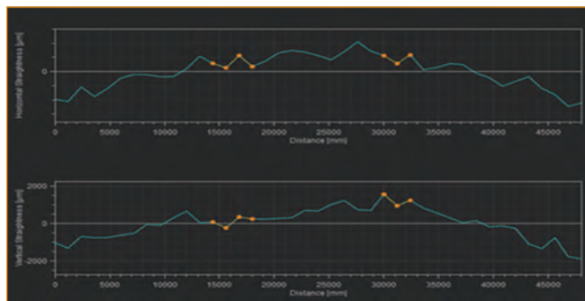
45 m导轨的长距离直线度测量
