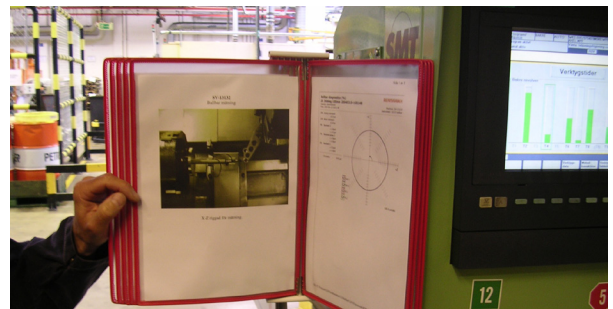
工場全体が一貫したテスト条件の下で実施するよう、機械一台ごとに写真つきの分かりやすいテスト作業の手順書を配備
