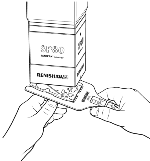
Abb. 21 - Montage der SH80/SH80K Halter am SP80/SP80H Gehäuse
