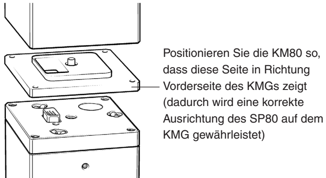
Abb. 18 - Ausrichtung und Befestigung der KM80 an der Pinole
