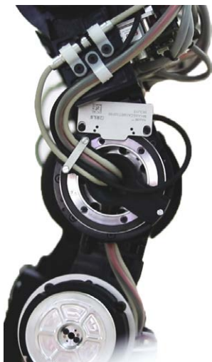
REEM-C Kniegelenk mit Absolut-Winkelmesssystem AksIM™
