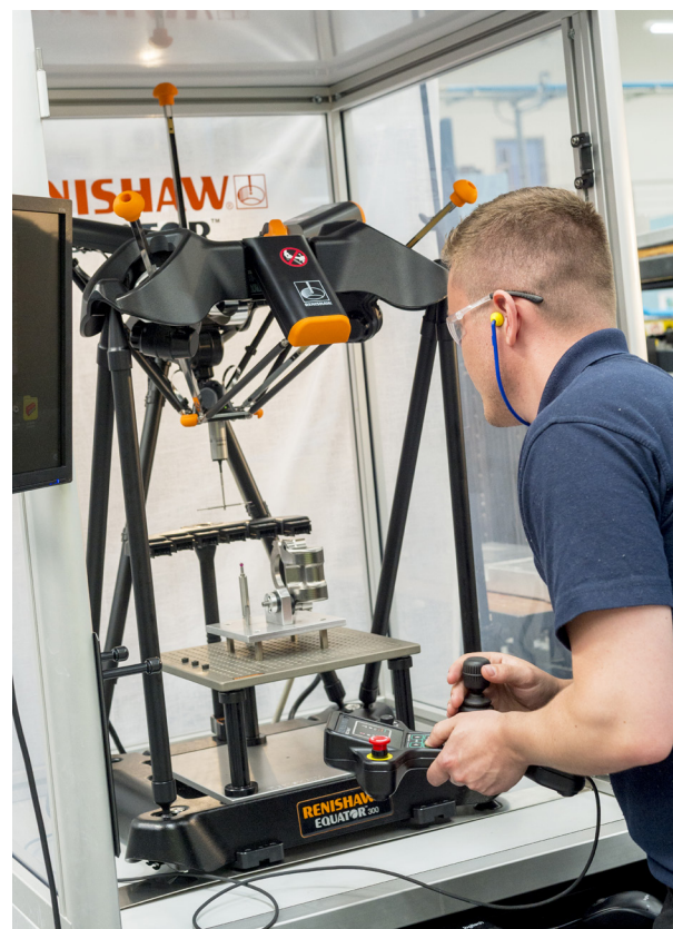
Equator Prüfgerät bei der Prüfung eines programmierten Luftfahrtteils
