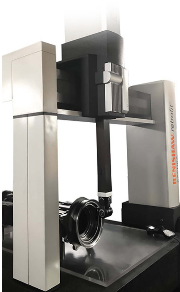
Systém REVO při měření komponentu lokomotivy
