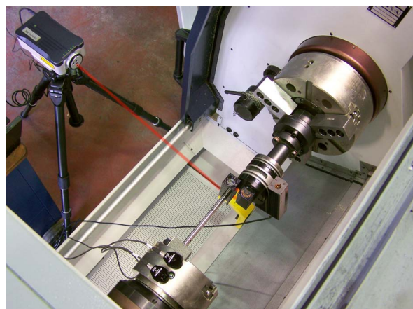
Kalibrace pomocného vřetena CNC soustružnického centra pomocí kalibrátoru Renishaw RX10
