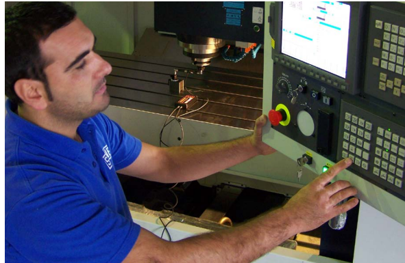
Test systémem QC10 trvá pouze několik minut. Společnost Spinner tento test využívá k nastavení parametrů řídicího systému geometrických chyb vzniklých při instalaci stroje u zákazníka
