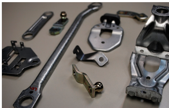
Eponsa vyrábí všechny lisované součásti mechanismu stěrače čelního skla
