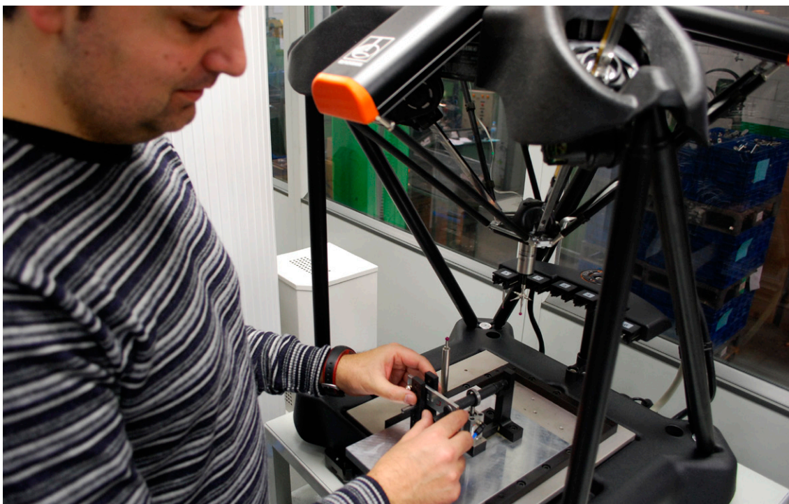
Eponsa – technik zakládá část mechanismu stěrače do přístroje Equator připraveného k měření
