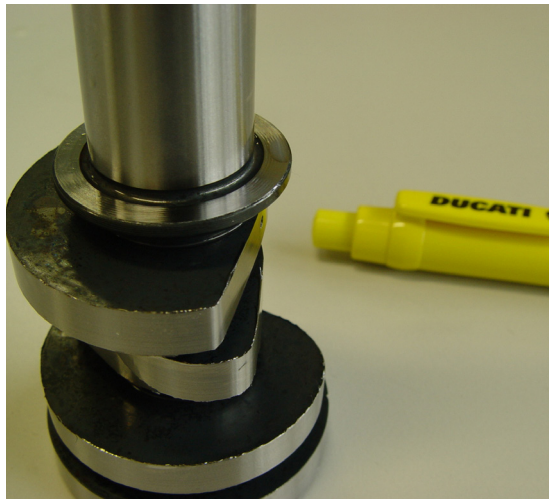
Desmodromická vačková hřídel není klasická a byla navržena se speciálními „zdvihacími rampami“
