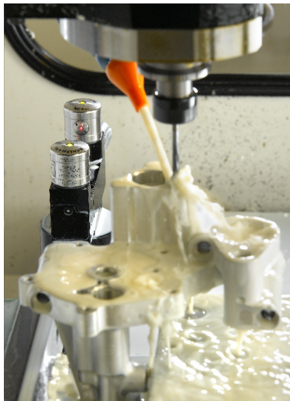
Systém NC4 firmy Renishaw se používá k předcházení škod způsobených poškozenými nástroji u velmi drahých dílů – eliminuje výsledný počet zmetků, přepracování a nevyužitý čas.
