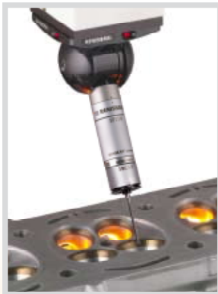
Dělicí skenovací sonda SP25M s vysokou přesností
