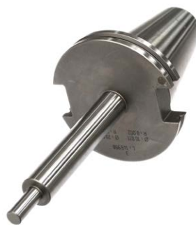
Kalibrační trn (nástroj o známé délce)
