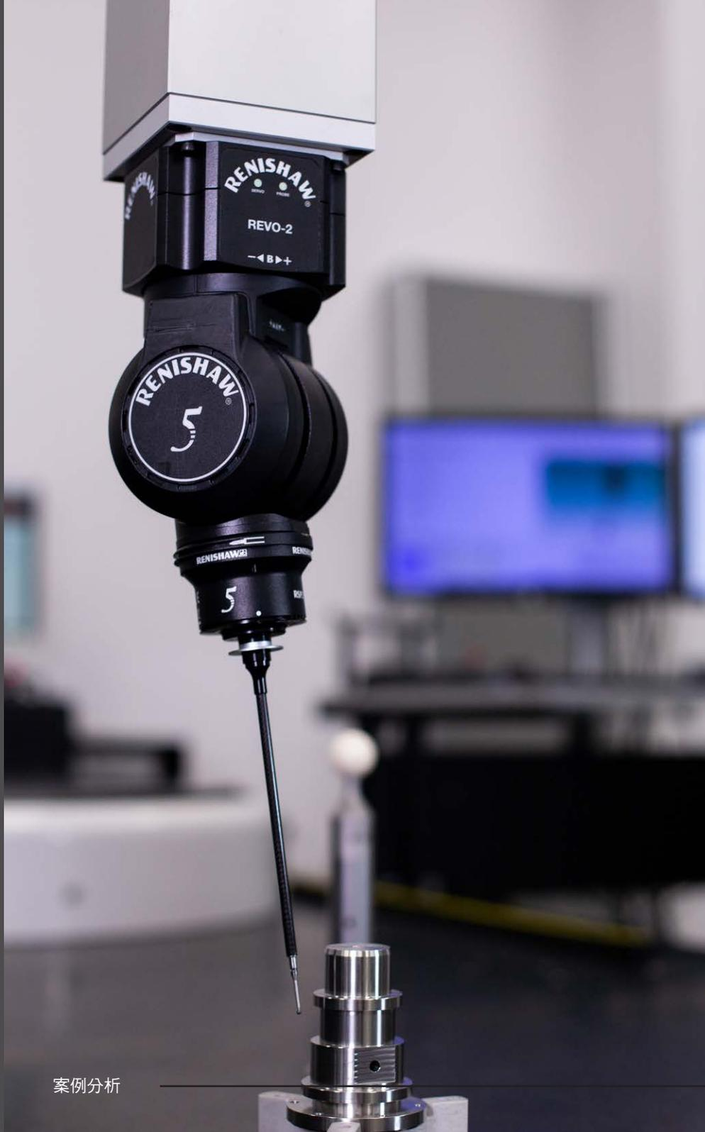
Renishaw Central 收集量測結果之後，透過智慧製程控制（IPC）模組利用客戶定義的限值計算閉迴路製程控制回饋。這套靈活的系統可以運用來自任何設備的量測數據，依照需求自動控制任何其他 CNC 工具機上的製程，如刀補更新。手動更改刀補可能會導致整個製程出現錯誤和品質問題。IPC 可以使用量測數據自動更新工具機控制器上的刀補，進而避免這種不確定因素。IPC 還可以實現即時品質監控。
