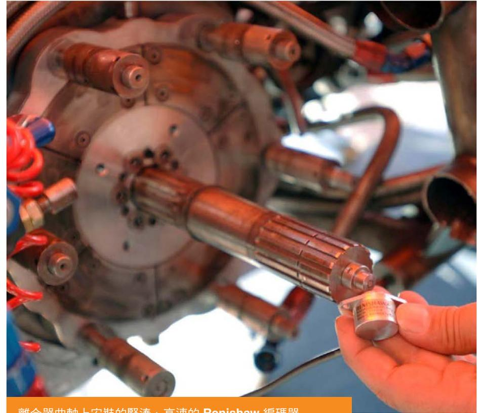
離合器曲軸上安裝的緊湊、高速的 Renishaw 編碼器
