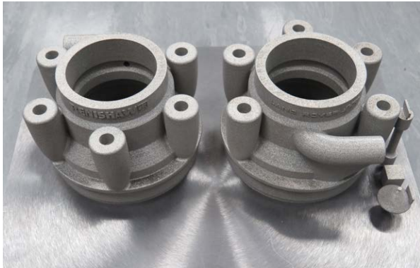
Land Rover BAR 金屬積層製造歧管展示在建構基板上
