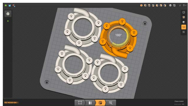
Land Rover BAR 金屬積層製造歧管展示在 QuantAM 軟體中
