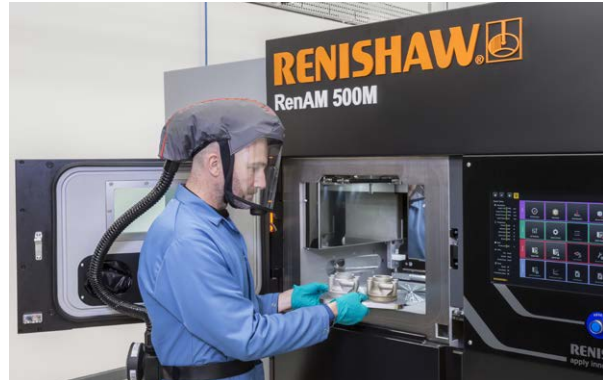
由 Renishaw RenAM 500M 金屬積層製造系統取下展示用 Land Rover BAR 金屬積層製造歧管
