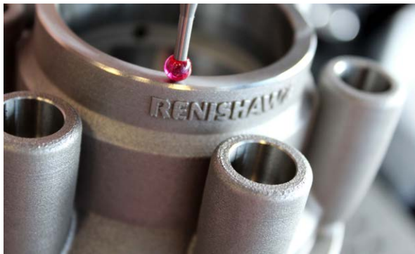
展示用 Land Rover BAR 金屬積層製造液壓歧管
