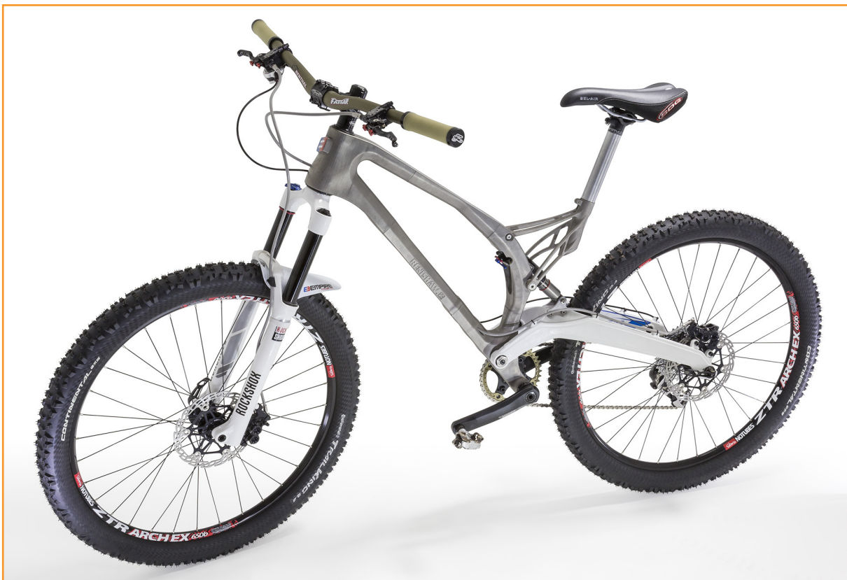
Kompletno kolo z okvirjem in nosilcem sedežne cevi, ki sta izdelana iz titanove zlitine po postopku 3D-tiskanja
