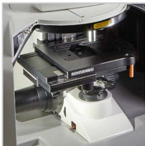
Предметный столик микроскопа Renishaw MS30 с программным управлением. Более 40 лет наши изделия обеспечивают точную и надежную работу на переднем крае высокоточных измерений.
