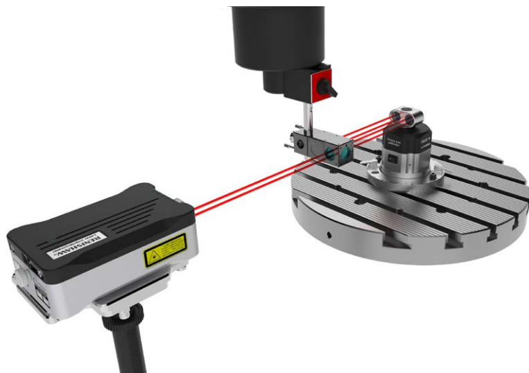
Рисунок 1. Типовая конфигурация системы для калибровки поворотной оси с использованием XL-80 в качестве лазерной измерительной базы.
