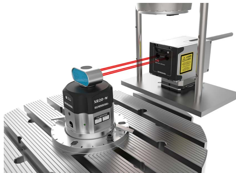
Рисунок 2. Типовая конфигурация системы для калибровки поворотной оси с использованием XM в качестве лазерной измерительной базы.
