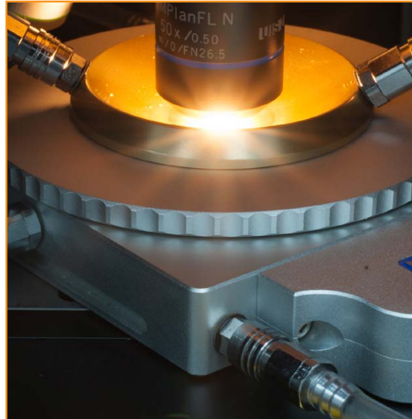
Использование функции LiveTrack для удержания фокуса на поверхности образца в высокотемпературной ячейке.
