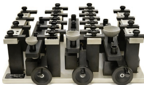
Специальное приспособление для одновременного крепления семейства деталей разного размера.
