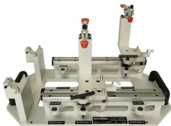
Линейные направляющие позволяют работать с несколькими деталями разной длины.
