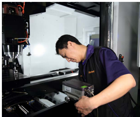
Работник Hartford выполняет калибровку станка с помощью лазерного интерферометра XL-80
