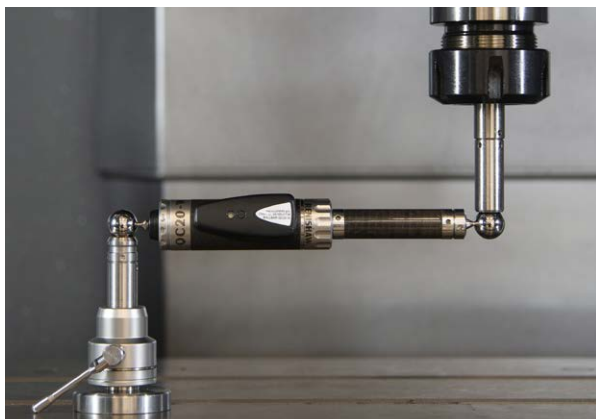
Hartford использует систему Renishaw QC20-W ballbar для контроля точности позиционирования станков
