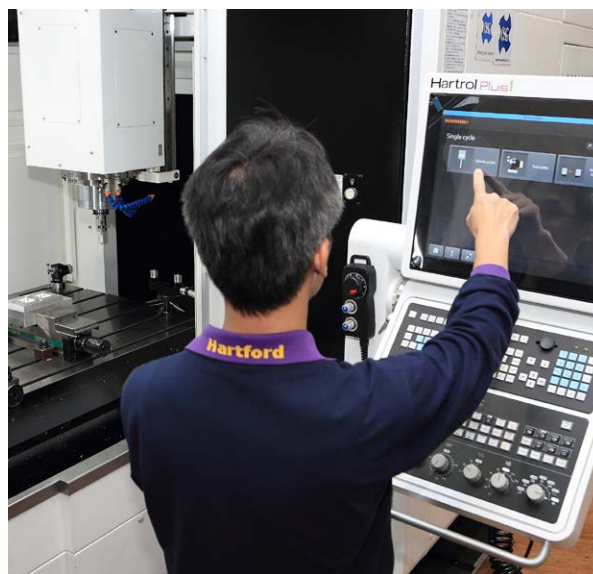
Станочное приложение Set and Inspect, встроенное в контроллер ЧПУ Hartford Plus
