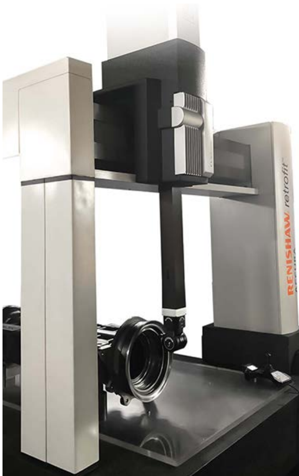
REVO измеряет толстостенную трубу, используемую в локомотивостроении
