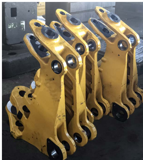
Детали поворотной платформы, используемой в производстве землеройного оборудования
