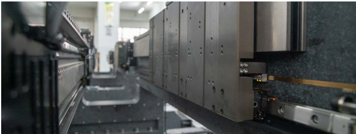
RGSZ20S スケール - 機材と同じ熱伸縮を見せる
