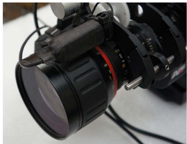
カメラヘッドに取り付けられた Power Plus 社のフィードバックデバイス
