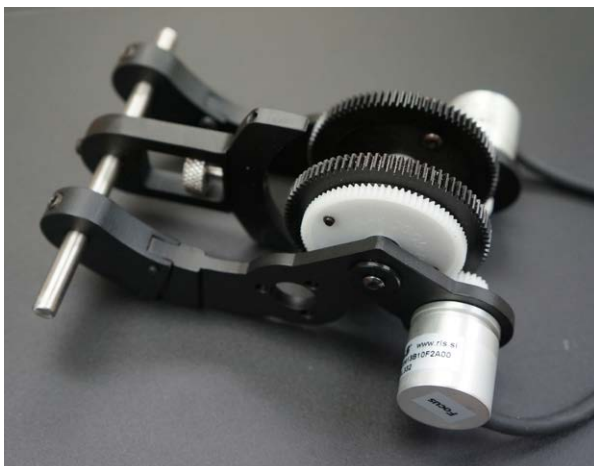
パンチルトヘッドの位置についてのフィードバックを送る RE22。生放送中にカメラが安定して正確に動作するために不可欠な情報である。
