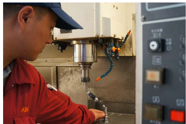
ASMPT の製造スタッフが定期的に工作機械キャリブレーションを実施
