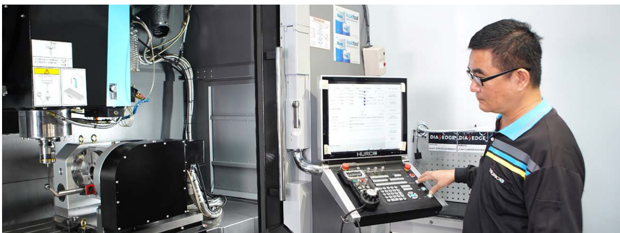
Hurco Manufacturing 社では、ワーク計測と芯出しに RMP600 高精度プローブも使われている
