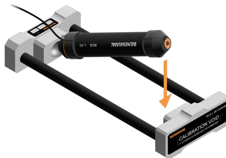
2. キャリブレータの反対側の球に届くようボールバーを伸ばします。RCS L-90 ボールバーが磁力でキャリブレータに装着されたことを確認します。
