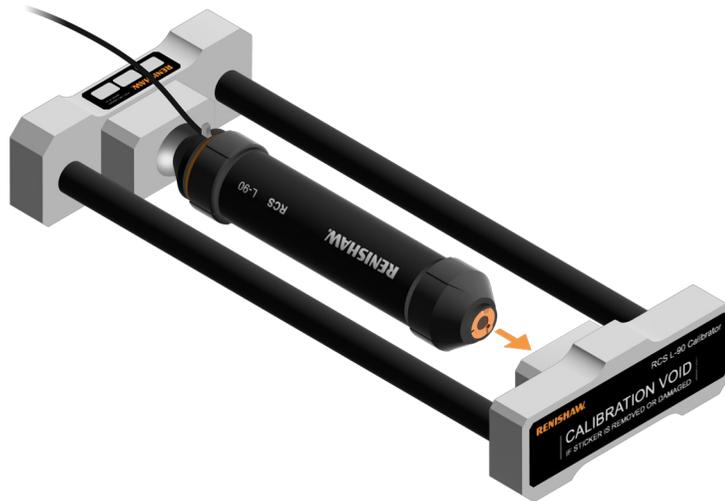
3. 取外しは、逆の手順で行います。ケーブルが出ていない側の端部を押してボールバーを縮めて、キャリブレータから取り外してください。
