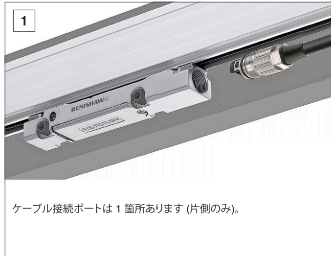
ケーブルをリードヘッドに挿入します。コネクタの向きに注意してください。コネクタのキーのエッジが、リードヘッド底面側を向きます。
