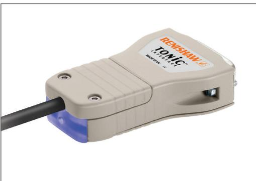
**Ti** インターフェースは、高速性、低周期誤差、分解能 1nm までのデジタル内挿分割を必要とする場合に適しており、CAL ボタンが実装されています。クロック出力は、業界標準コントローラ用のすべての分解能で最適な性能を発揮するように最適化されています。アナログタイプもあります。
