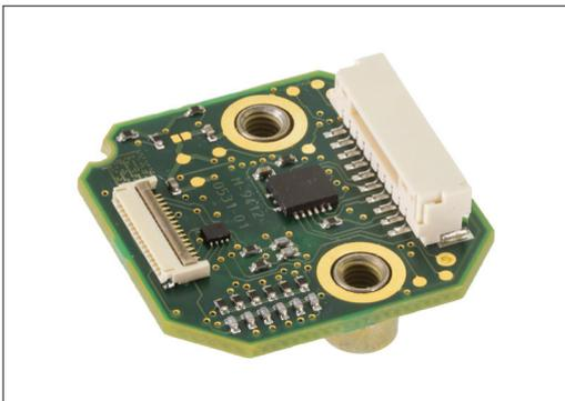
**ACi** インターフェースは、高性能かつ小型で、コネクタの筐体がないオープンタイプの内挿分割システムです。コンパクト、オープンタイプ、省取付け面積で高分解能と高速性能の両立を求めるモーションシステムで優れたコストパフォーマンスを発揮します。システムのキャリブレーションも実施可能です。最高 40MHz のクロック出力で、10nm までのデジタル内挿分割に対応します。FPC 入力タイプとケーブル入力タイプがあります。
