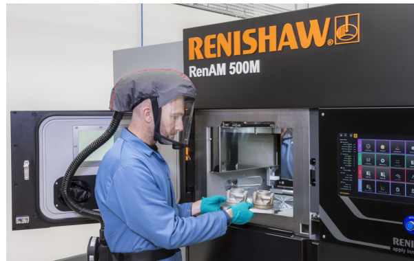
Retirada de los colectores de muestra de AM de Land Rover BAR de la máquina de fabricación aditiva metálica RenAM 500M de Renishaw
