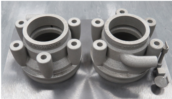
Colectores de AM metálica del Land Rover BAR en la placa de montaje
