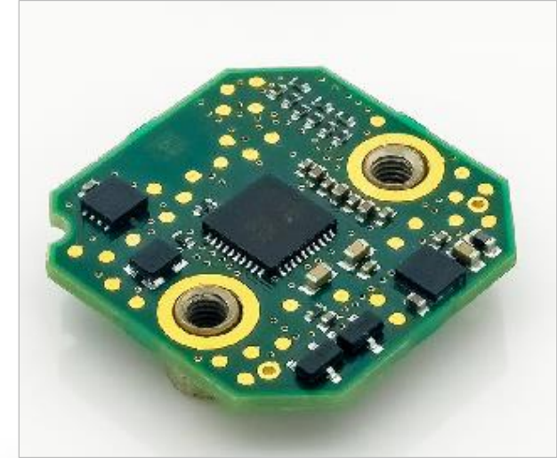
ATOM miniature encoder PCB
