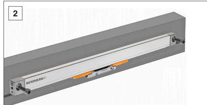
Befestigen Sie das Stranggussprofil locker mit den beiden mitgelieferten gezackten Unterlegscheiben und M8-Schrauben in den Montagebohrungen der Endkappe.
