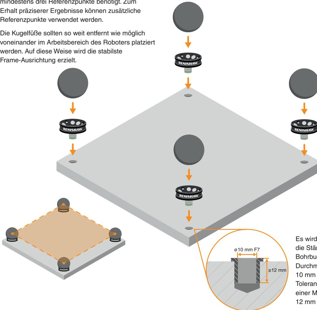
Es wird empfohlen, die Ständer in eine Bohrbuchse mit einem Durchmesser von 10 mm und einer Toleranz von F7 sowie einer Mindestdiefe von 12 mm zu sichern.
